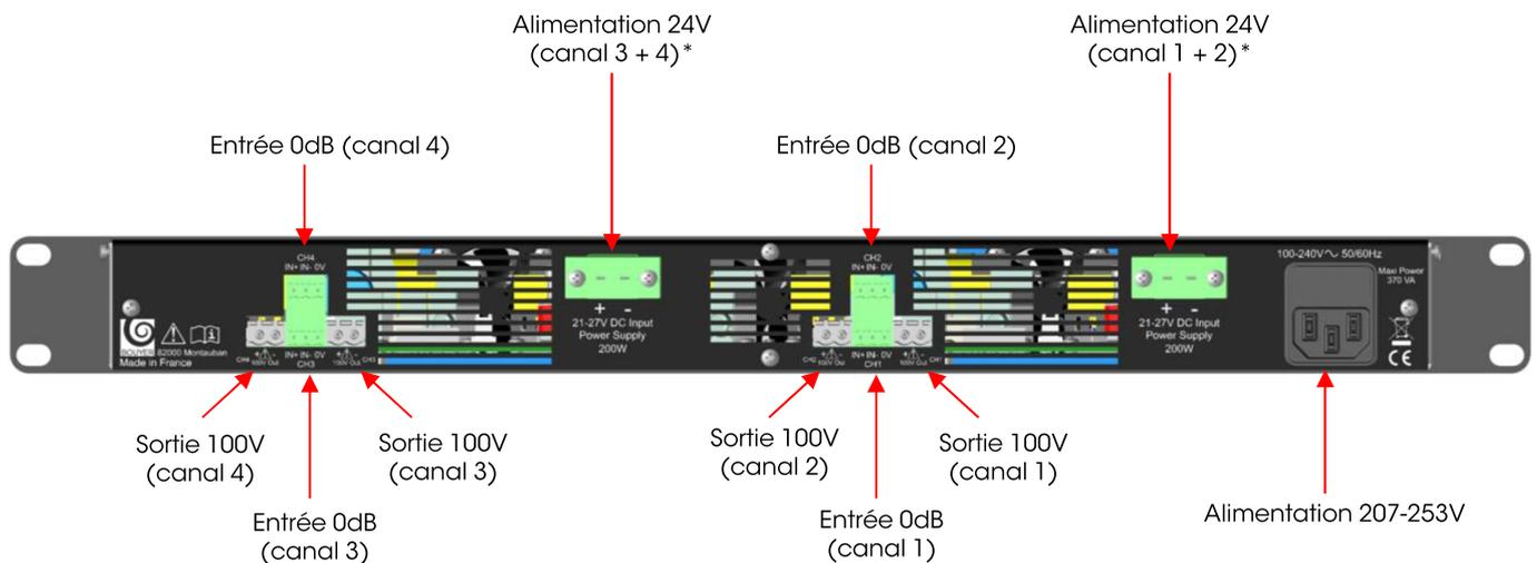
\* Alimentation 24V séparée en deux entrées sur les versions 4 canaux afin de limiter le courant admissible par entrée
